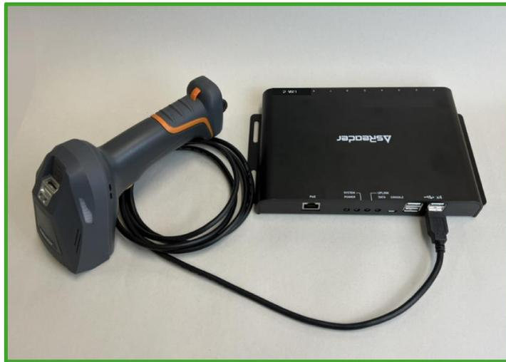
図 2-2-1 バーコードスキャナの接続
