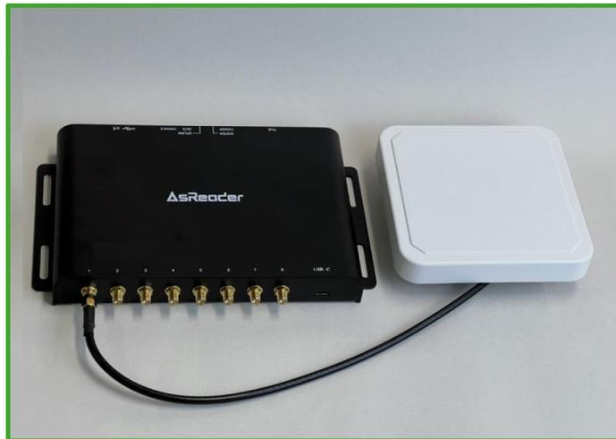
図 2-1-1 アンテナの接続
