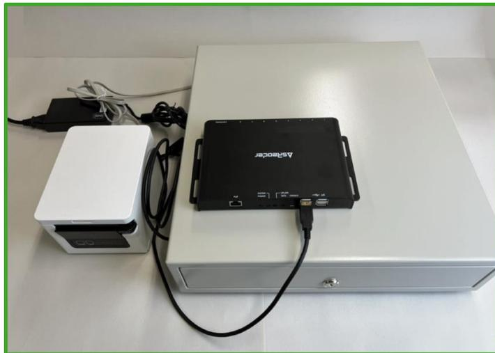
図 2-4-1 キャッシュドローアの接続
